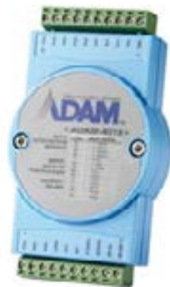
شکل ۵ - ماژول Remote I/O برای خواندن ترموکوپل
